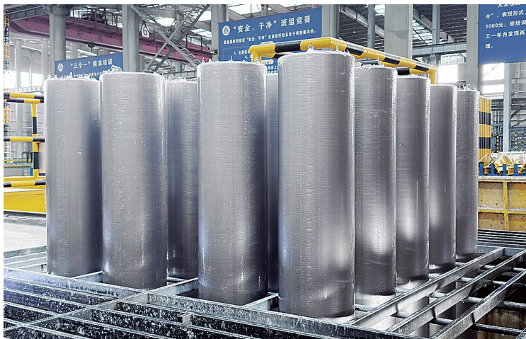
图为云铝海鑫生产的大规模稀土合金油气滑圆棒。 李章钰 摄
