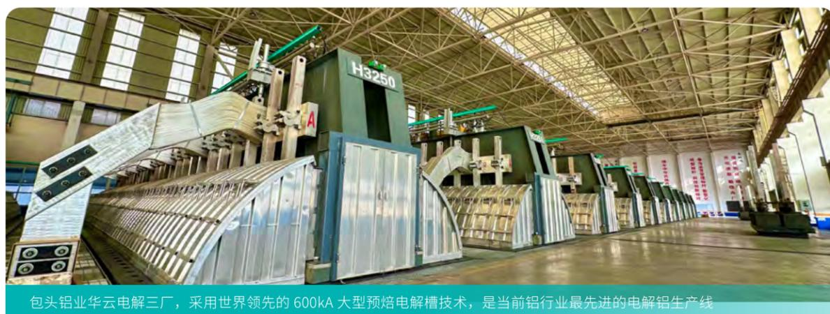
包头铝业华云电解三厂，采用世界领先的 600kA 大型预焙电解槽技术，是当前铝行业最先进的电解铝生产线
